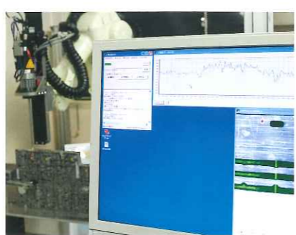
右：シグマ本社のショールームで、ロボットに取り付けて使うレーザー傷検査装置「穴ライザー」を手に開発経緯を語る。社長室室長兼LIS事業部部長の江崎泰史氏/左：量産ラインの目視検査の自動化を実現した穴ライザーは、独自の欠陥検出アルゴリズムに基づき非破壊・非接触で製品の良否判定を行う。検査データはリアルタイムでグラフ化され、モニターに表示される
