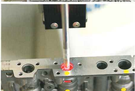
穴ライザーは、高速で回転するプローブの先端部からレーザー光を横向きに発してワーク(検査対象物)の穴の内壁に当て、反射光を受光してデータ化する。傷などで凹凸がある部分は受光量に変化が見られることから、受光量が周囲と極端に異なる部分を欠陥候補と見なし、設定された閾値(しきいち)(サイズなど)をもとに自動的に良否判定を行う
